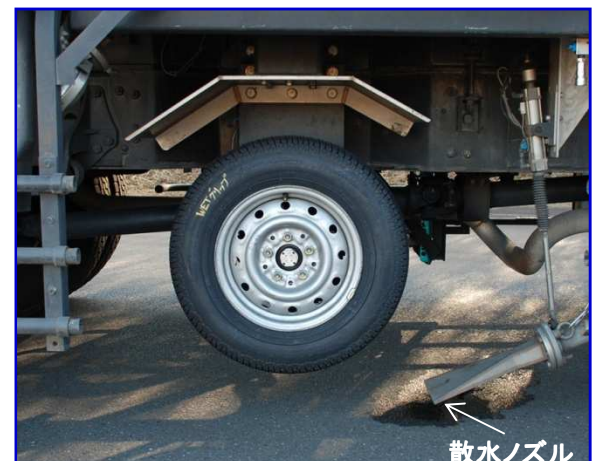
路上タイヤ試験車測定輪 (右前輪と右後輪の間に装備)
